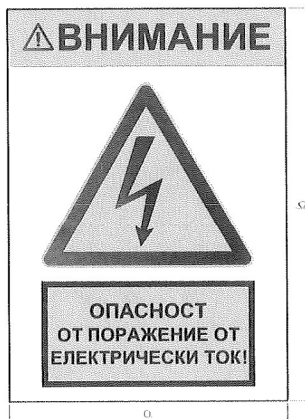
Табела „Внимание! Опасност от поражение от електрически ток!“
